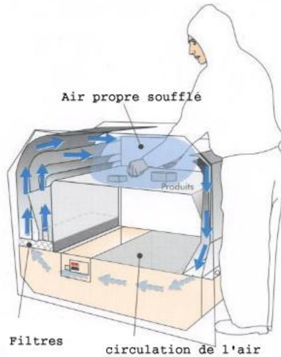
FIG. 1.1 – Exemple d’une technique de protection localisée des produits alimentaires, mise au point par le Cemagref, par l’utilisation d’un air propre soufflé dans un air ambiant pollué : “Flux progressif”.
