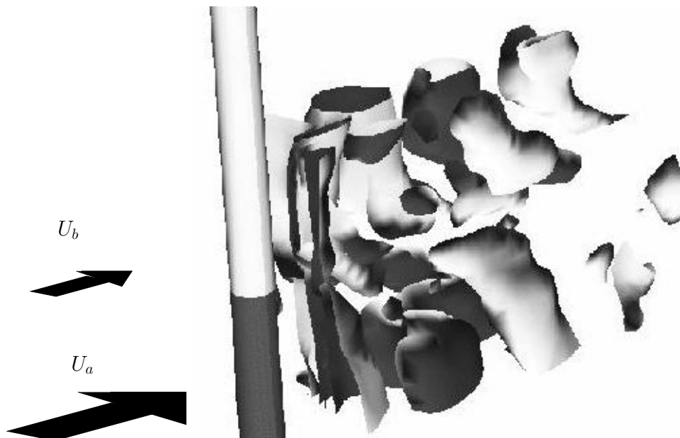
FIG. 7.25 – Isocontours positif (gris clair) et négatif (gris foncé) du vecteur propre \sqrt{\lambda^{(8)}}\Phi_u^{(8)} = \pm 0,02 . Mesures PIV.
