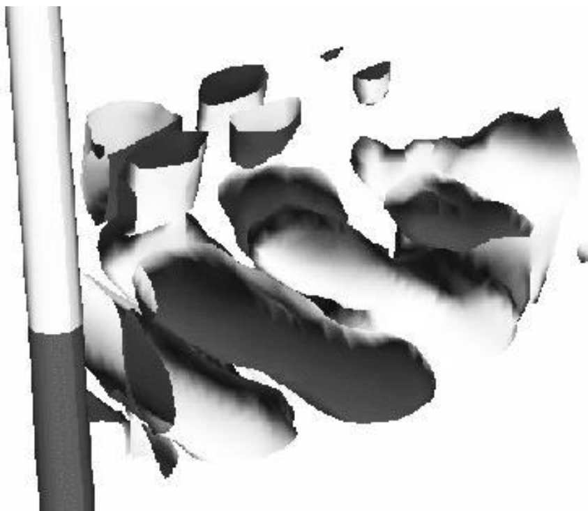
FIG. 7.18 – Isocontours positif (noir) et négatif (gris) des vecteurs propres POD : \sqrt{\lambda^{(1)}}\Phi_v^{(1)} = \pm 0,02 . Mesures PIV.
