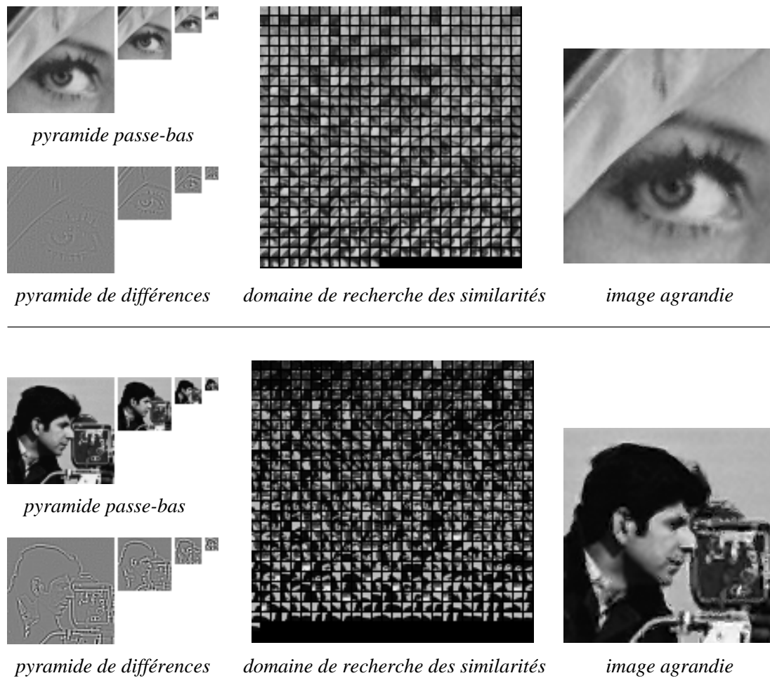
Figure 5.16 – Agrandissement de facteur 2 des images de Lenna et du cameraman par synthèse de similarités sur une pyramide. Les paramètres utilisés sont ceux de la configuration standard. Les niveaux de gris de la pyramide de différences sont amplifiés d'un facteur 2.
