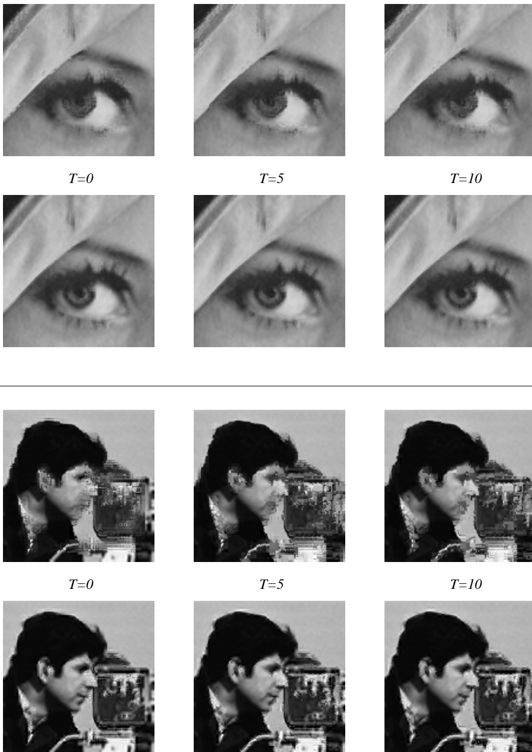
Figure 5.25 – Agrandissements de facteur 2 des images de Lenna et du cameraman obtenus en effectuant une recherche locale des similarités et en faisant varier le paramètre T . Pour chaque couple d'agrandissements, celui du haut est obtenu sans utiliser les résidus de transformation lors de la synthèse des similarités, et celui du bas est obtenu en les utilisant.
