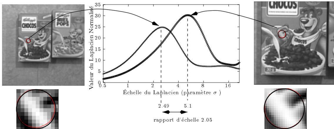
FIG. 3.16 – Sélection automatique de l'échelle pour évaluer des appariements de points entre deux images. Les courbes présentent l'évolution du Laplacien Normalisé avec  $\sigma$ . Les cercles montrent un rayon  $2\sigma_0$  ( $\sigma_0$  est le paramètre d'échelle sélectionné). Le rapport entre les  $\sigma_0$  donne un rapport d'échelle approximatif de 2 entre les images.
