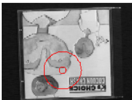
FIG. 3.18 – Exemple de détection de maxima du Laplacien Normalisé. Cet exemple montre un point où deux maxima sont disponibles et donc deux échelles caractéristiques. Les cercles sont tracés en prenant pour centre le point évalué et pour rayon 2\sigma avec \sigma les paramètres d'échelles sélectionnés.
