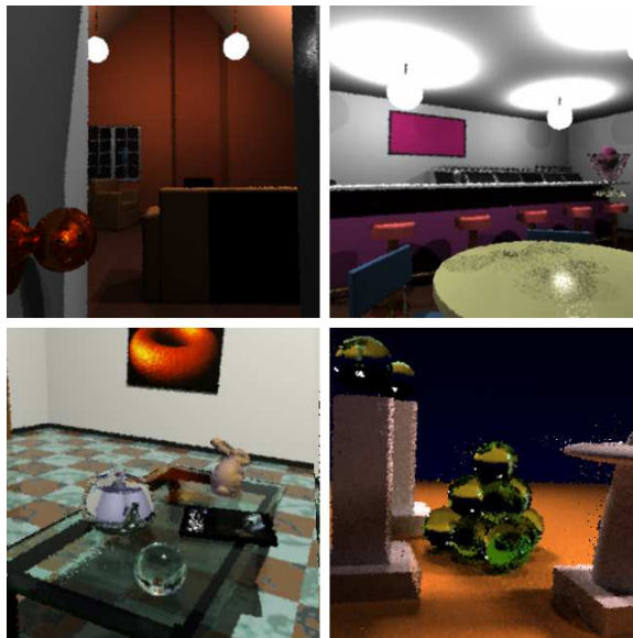
FIG. 4.8: Images d'une série d'utilisations interactives du render cache . Notez que toutes les images sont créées par lancer de rayons, à l'exception de l'image en bas à droite, qui est créée par tracer de chemins. Dans cette dernière image on distingue les effets des caustiques (sous les sphère en verre), très coûteux à produire habituellement.
