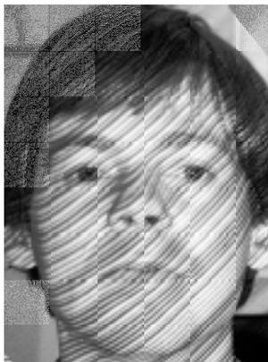
*Dans les deux cas, des faisceaux de lumière trahissent le relief de la surface interceptée. À gauche, c'est un faisceau laser plan qui est en rotation relative par rapport au modèle, et permet en quelques secondes la reconstruction d'un modèle complet. Sur l'image de droite [BA99], la projection d'un motif spécialement choisi pour être non répétitif et éviter les ambiguïtés permet la capture en une seule image, mais la reconstruction du visage sera partielle.*
