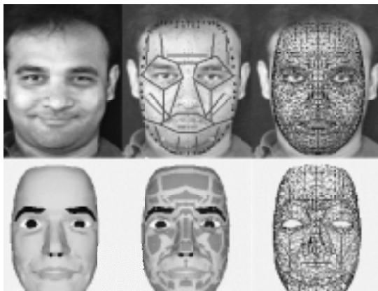
FIG. 4.5 – Estimation des contractions des muscles selon un flot optique par régions [Ess95]
