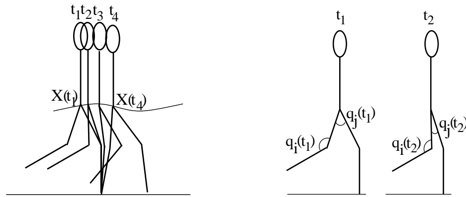
a) Interpolation des coordonnées cartésiennes. b) Interpolation des coordonnées articulaires.
