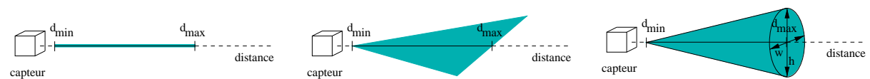
a) Ligne de vision de capteur 1D. b) Plan de vision de capteur 2D. c) Cône de vision de capteur 3D.
