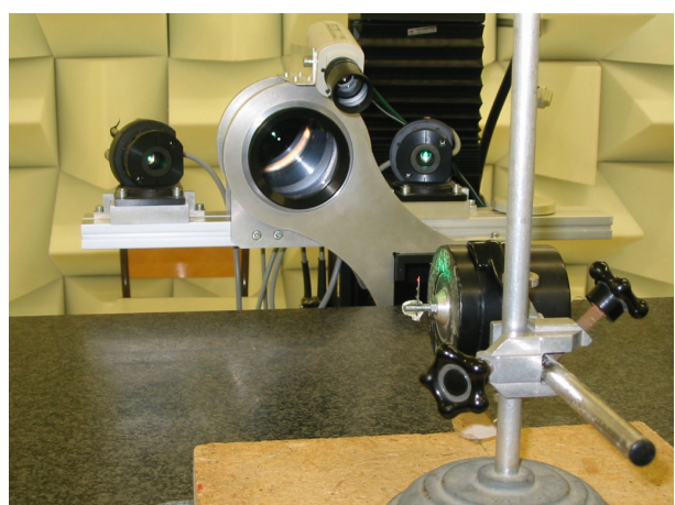
FIG. 5.5 – Dispositif expérimental de mesure de la vitesse de la pointe d'une aiguille : vue de détail montrant le pot vibrant et le dispositif d'émission et de réception de l'anémomètre laser.
