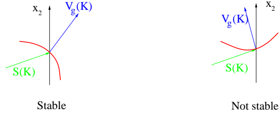
FIG. 3.1: Deux configurations différentes. Gauche: le vecteur lenteur \mathcal{S} et la vitesse de groupe \mathbf{V}_g sont orientés dans le même sens par rapport à l'axe Ox_2 . Droite: \mathcal{S} et \mathbf{V}_g ne sont pas orientés dans le même sens par rapport à l'axe Ox_2 .
