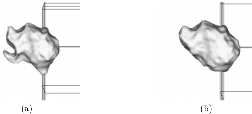
FIG. 6.10 – Résultat finaux sur l'image « chromo » (recherche de l'iso-valeur 40,0 sur 256) : (a) approche directe ; (b) approche multi-résolution
