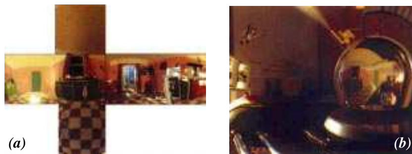
FIG. 2.2 – Simulation de réflexion miroir avec la technique du Z-buffer: (a) 6 cartes d'environnement correspondant aux 6 faces d'un cube sont calculées, (b) les cartes d'environnement servent de texture pour la surface réfléchissante de la bouilloire [WW92].
