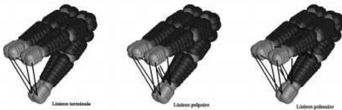
Figure 5.11: Le mouvement de la main est contrôlé par des forces qui lient les différents doigts. Les points où les forces sont appliquées dépendent de la nature de la saisie. 1) saisie par les bouts des doigts 2) saisie pulpaire 3) saisie palmaire.
