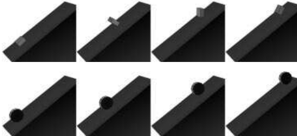
Figure 4.20: La différence entre le comportement d'une roue qui tourne sur la rampe tout en restant collée avec elle, et le comportement d'un cube qui quitte la rampe plusieurs fois pendant la chute.
