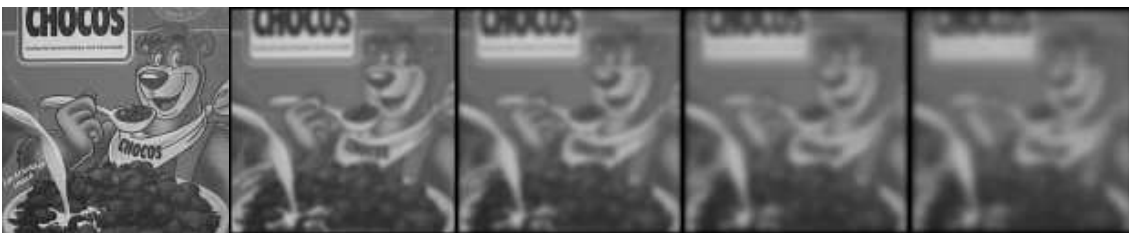
FIG. 5.3 – Stabilité par rapport au flou : une de 500 images filtrées plusieurs fois par une masque de 3 \times 3 : 2, 4, 7 et 10 fois
