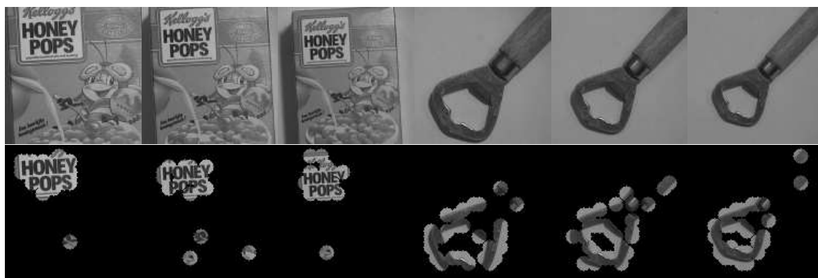
FIG. 8.5 – Robustesse de détecteur de points d'intérêt par rapport aux changements d'échelle. Le changement d'échelle est approximativement 20%
