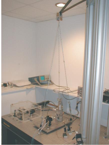
FIG. 5.6 – Dispositif expérimental de réduction du bruit environnemental.
