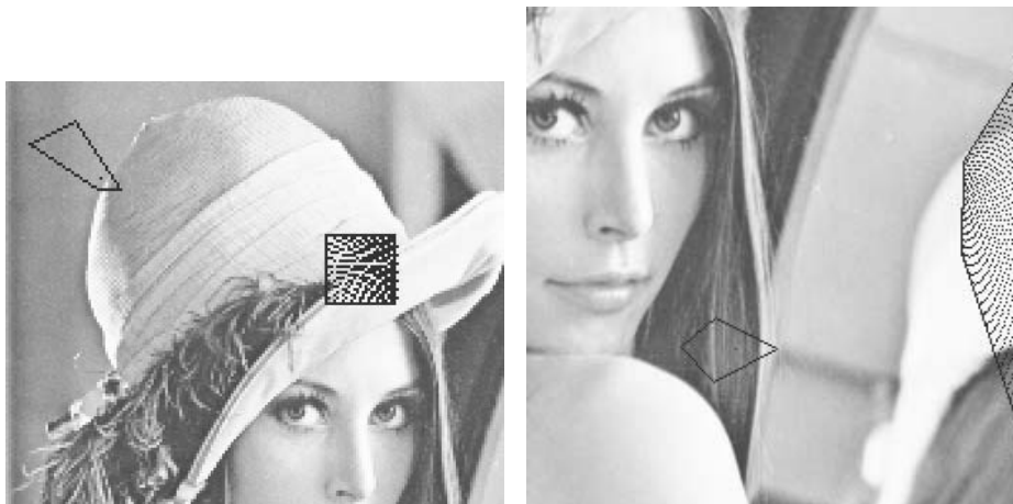
FIG. 81 - Deux exemples de transformations bilinéaires \omega_i d'un bloc source sur un bloc destination. Illustration du sous-échantillonnage du bloc source en transformant chaque pixel du bloc destination par \omega_i^{-1} .
