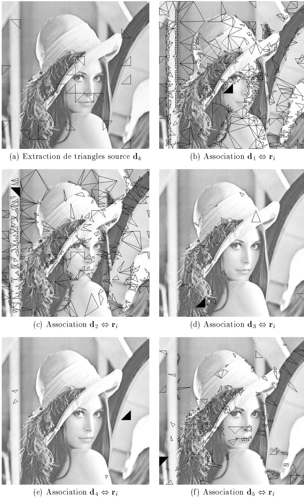
FIG. 87 - Associations après codage : blocs destination en traits fins, blocs source en noir.
