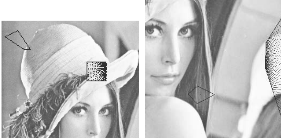
FIG. 75 - Deux exemples de transformations projectives \omega_i d'un bloc source sur un bloc destination. Illustration du sous-échantillonnage du bloc source en transformant chaque pixel du bloc destination par \omega_i^{-1} .
