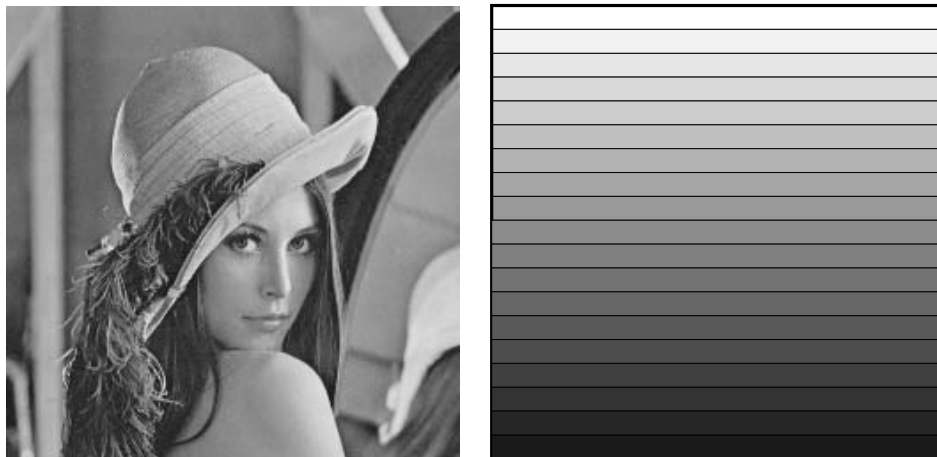
FIG. 22 - A gauche : image présentant des similarités locales à diverses échelles. A droite : image auto-similaire, ne pouvant cependant pas être compressée par transformation fractale puisqu'aucune zone de l'image ne ressemble à une autre zone de taille supérieure.
