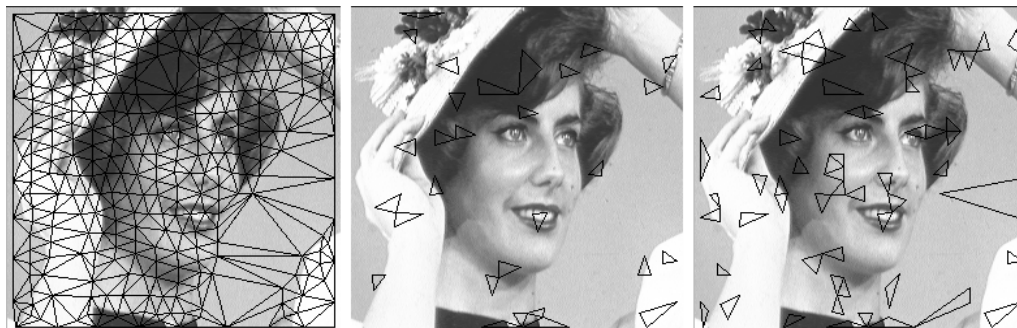
FIG. 86 - Quantification d'une triangulation de l'image Femme. De gauche à droite : 576 triangles initiaux puis 32 et 64 triangles quantifiés.
