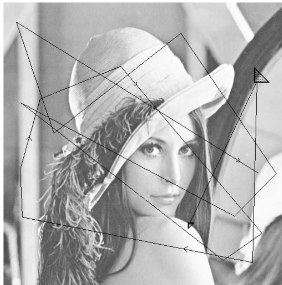
FIG. 52 - Suivi de la reconstruction d'un pixel au cours du décodage (15 itérations). Le pixel r à l'intérieur du petit triangle destination est issu de la transformation du pixel d inclu dans le triangle source de plus grande taille. Le pixel d est lui-même à l'intérieur d'un autre triangle destination. Il est associé à un autre pixel d'un autre bloc source. En continuant ce raisonnement, nous remontons jusqu'au quinzième pixel.
