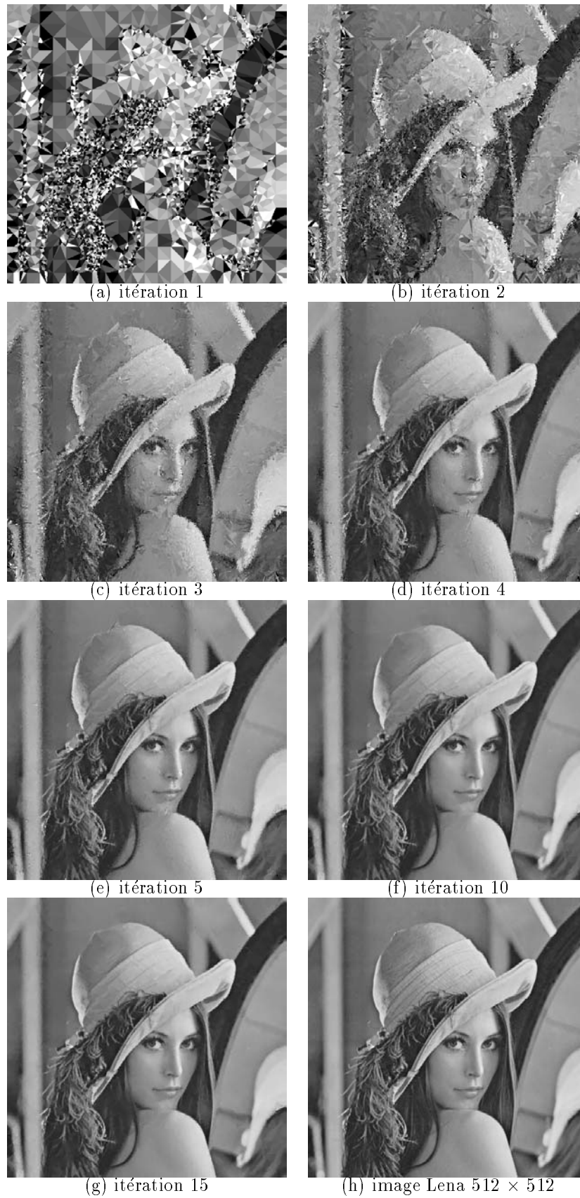
FIG. 51 - Décodage de l'image Lena. itération 15 : T_c = 11.2 : 1 , PSNR = 32.29 dB
