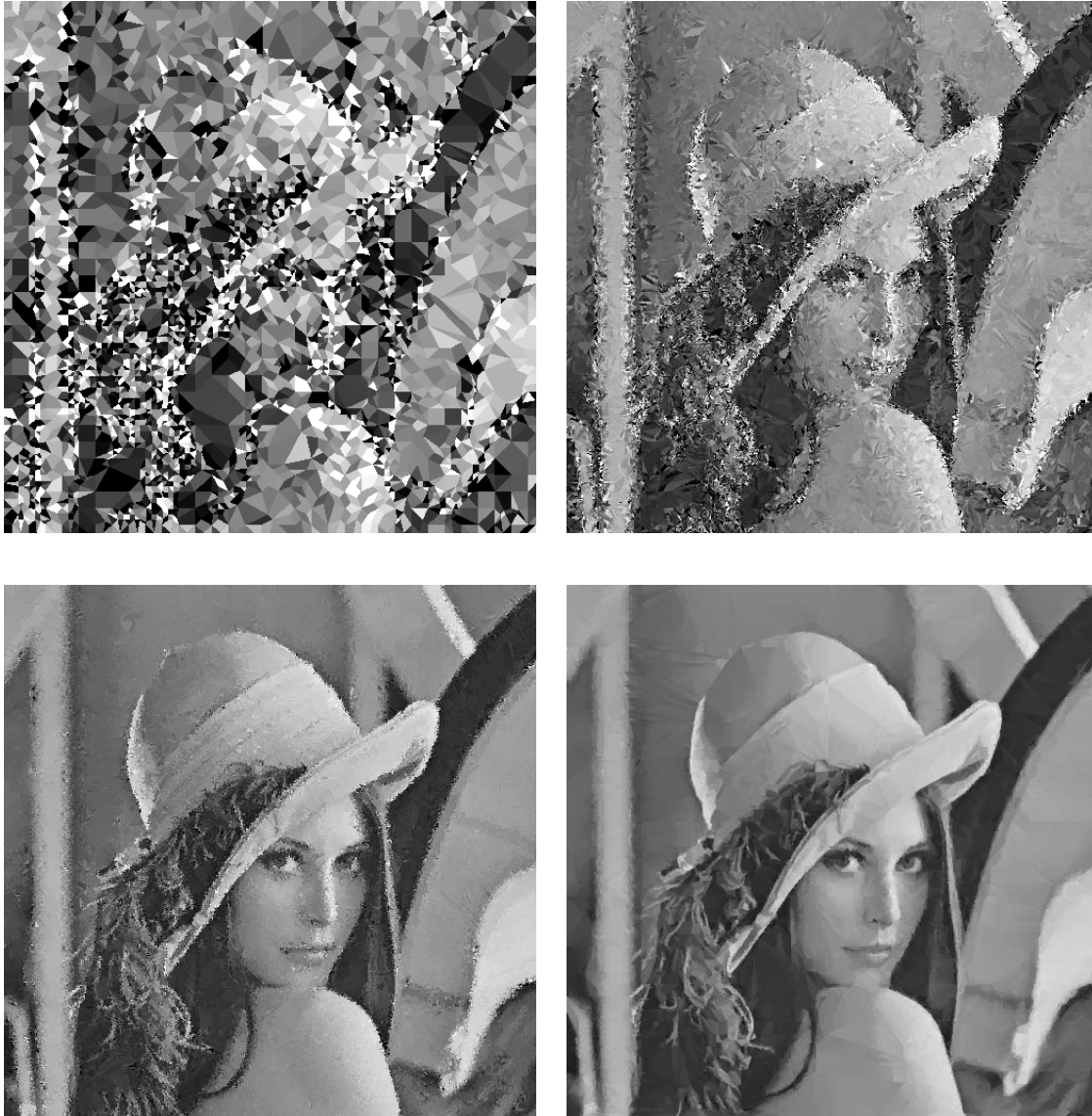
FIG. 82 - Partition R composée de 2988 triangles et de 2176 quadrilatères, partition D composée de 1052 triangles et de 407 quadrilatères. Itérations 1, 2 puis 3. L'image reconstruite est en bas à droite (taux de compression = 15:1, PSNR = 32.2 dB).
