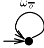
Figure 1.1: automate exprimant l'absence d'émission de la sortie o dans un système réactif
