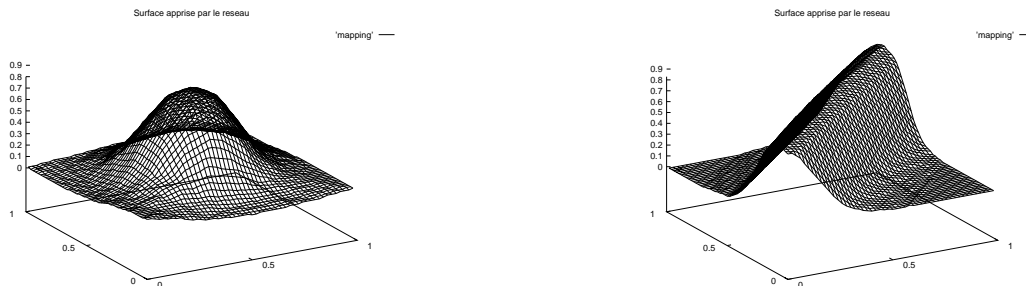
FIG. 7.3 - : Les fonctions proposées par le réseau de la figure de gauche et de la figure de droite passent toutes les deux par les points imposés. Mais seule la fonction de la figure de gauche généralise correctement.
