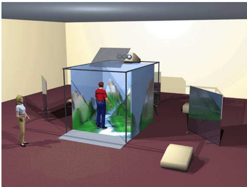
Figure 11.1 Système immersif multiprojection de Réalité Virtuelle appelé CAVE
