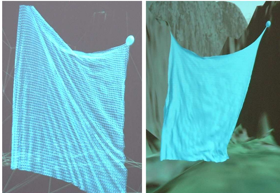
Figure 11.4 Représentation d'un morceau de tissu. Le textile est discrétisé en un maillage triangulaire de particules. Chacun des triangles est appelé facette. Le tissu peut être affiché en mode filaire (à gauche) ou bien il est possible de lui appliqué une texture (à droite).
