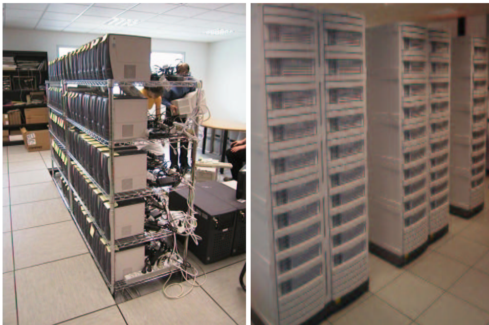
Figure 6.4 (A gauche) Grappe de PCs du projet iCluster (HP, INRIA, ID-IMAG) composée de 226 mono-processeurs Pentium III à 733 MHz avec 256 Mo de mémoire, inter-connectés via un réseau de 100 Mbit/s. (A droite) Grappe du projet iCluster2 composée de 104 bi-processeurs Itanium-2, 64 bits à 900 MHz avec 3 Go de mémoire, inter-connectés par un réseau Myrinet.
