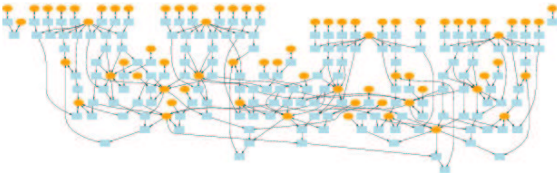
Figure 10.5 Graphe de flots de données associé à la simulation partitionnée en 4 sous-ensembles de particules lors de l'emploi d'une méthode d'intégration explicite
