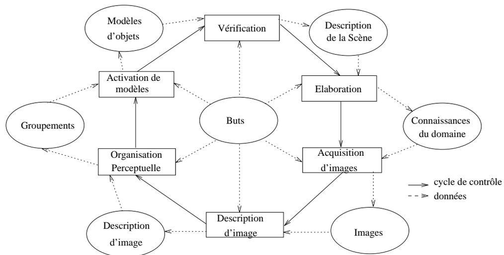
FIG. 3.2 - Cycle de contrôle du système *Vision As Process*. [Cro 90] Ce cycle de contrôle met en place un parcours de tous les niveaux de représentation du système. A la différence du cycle de perception l'acquisition de l'image est incluse dans ce cycle. Les caméras sont ainsi une part intégrante du système. Comme l'ensemble des autres traitements elles sont contrôlées par un ensemble de buts.
