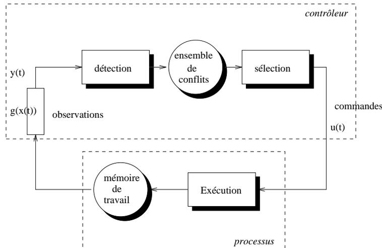
FIG. 2.3 - **Formulation d'un système de production en terme de contrôleur et de processus.** Le contrôleur est constitué des fonctions de construction de l'ensemble de conflits (*détection*) et de résolution de conflits (*sÉlection*). La commande qu'il émet en direction du processus est la règle instanciée à exécuter.
