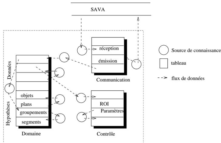
FIG. 4.6 - **Architecture du module d'interprétation.** Cette architecture est implantée à l'aide d'une architecture de blackboard. Les informations manipulées sont représentées par trois tableaux : tableau du domaine constitué des panneaux de *donnée* et d'*hypothèses*, tableau de communication, tableau de contrôle. Différentes sources de connaissances regroupent les connaissances permettant de manipuler ces informations.
