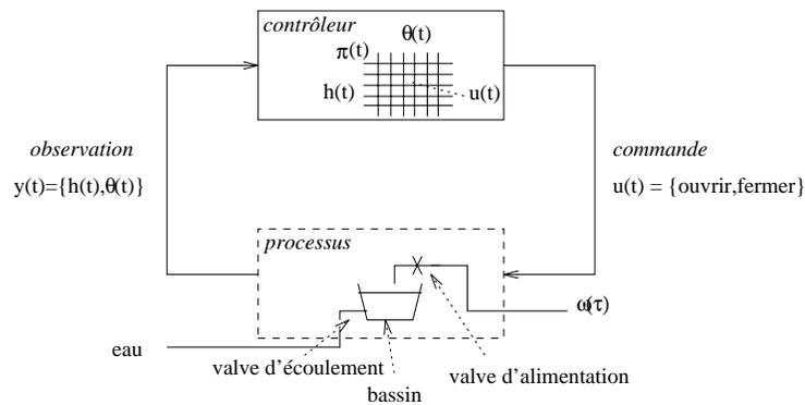
FIG. 2.1- **Contrôleur et Processus en Automatique.** Un contrôleur définit la modification à apporter à la valve d'alimentation d'un bassin afin que la hauteur d'eau soit constante. Les observations sont définies par la hauteur d'eau mesurée  $h(t)$  et la position de la valve  $\theta(t)$ . La loi de commande  $\pi(t)$  est exprimée par une table de décision faisant correspondre une valeur de commande pour les observations.
