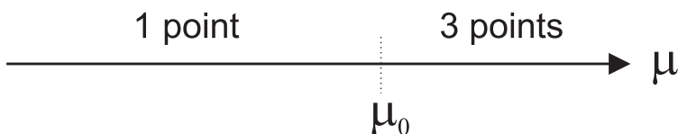
FIG. IV-2 – Courbe de bifurcation (ici le point \mu_0 ) dans l'espace des paramètres (ici l'axe \mu ).
