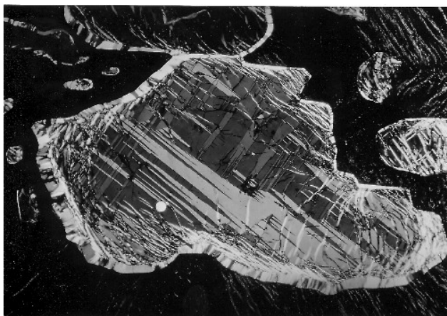
Figure 1.1 - Inclusion de coésite dans un grenat (noir). Les bords de l'inclusion sont partiellement transformés en quartz (plus net en bas de l'inclusion) et montrent des fractures radiales dans le grenat qui proviennent de la dilatation de la silice (+10%) lorsqu'elle passe de la structure cristalline compacte de la coésite à celle du quartz. La photo fait près de 4 mm de long. L'échantillon provient de l'unité à coésite du massif de Dora Maira dans les Alpes italiennes. Photo de O. Modenbach (Schreyer, 1995).
