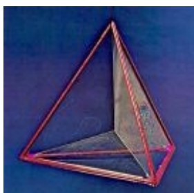
FIG. 1.4: Exemple d'une surface minimale créée en plongeant une structure en fil de fer dans de l'eau savonneuse. Ici la structure est un tétraèdre. On peut voir sur la figure que les films se rencontrent trois par trois en une arête avec des angles égaux, et que les quatre arêtes se rencontrent en un vertex.
