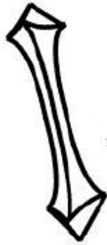
FIG. 1.20: Structure élémentaire dans laquelle est évaluée la dissipation, composée d'un bord de Plateau terminé par deux quarts de noeud.
