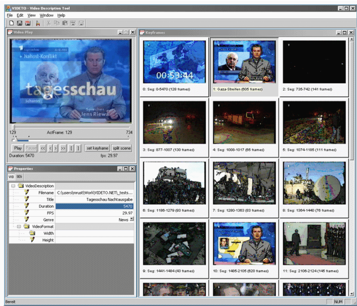
FIG. 2.10 – Interface de l'outil VIDETO. La vidéo (en haut à gauche) est découpée en plans (à droite) et est annotée en fonction d'un schéma (en bas à gauche)
