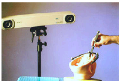
Figure 10 :Localisateur à marqueurs passifs (Polaris tm passif). La couronne autour des caméras émet la lumière et les sphères la réfléchissent vers le centre optique de la caméra
