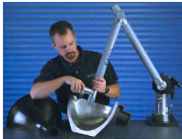
Figure 6 : Localisateur mécanique (le bras FARO)
