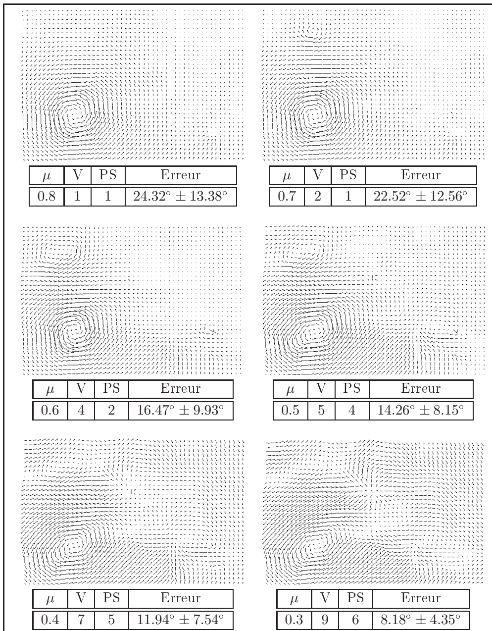
FIG. 8.10 – Influence du seuil \mu de la distance de Bhattacharyya. Pour six différentes valeurs de ce seuil, nous représentons le champ paramétrique reconstruit, le nombre V de vortex et le nombre PS de puits/sources détectés, ainsi que l'erreur vis à vis du champ de déplacement réel.
