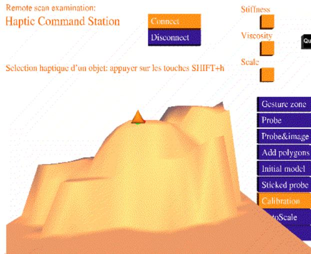
Le temps moyen pris pour réaliser un télé calibrage est de trois minutes. Le télé calibrage utilise le système de télé-palper pour permettre la construction 3D du maillage du modèle local de la patiente distante sans alourdir le système distant par la présence et la manipulation d'un capteur de position.
