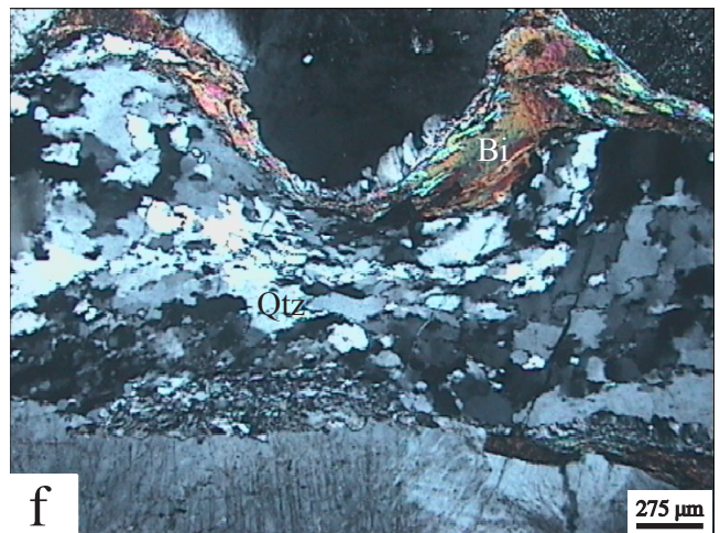
Fig. III-11. Microstructures du granite porphyroïde. (a), (b) Microstructures magmatiques montrant des grains de quartz à extinction franche et des biotites non déformées. (c) Microstructures de déformation modérée à l'état solide. Le quartz est légèrement recrystallisé avec un début de formation de néograins. Les biotites sont déformées. (d), (e), (f) Microstructures de déformation intense à l'état solide. (d) Quartz extrêmement recrystallisé avec une réduction de la taille des grains. (e) Biotite à extinction ondulée marquée. (f) Biotite en rubans et intense recrystallisation dynamique du quartz. Qtz : Quartz, Fk : Feldspath potassique, Pl : Plagioclase, Bi : Biotite.
