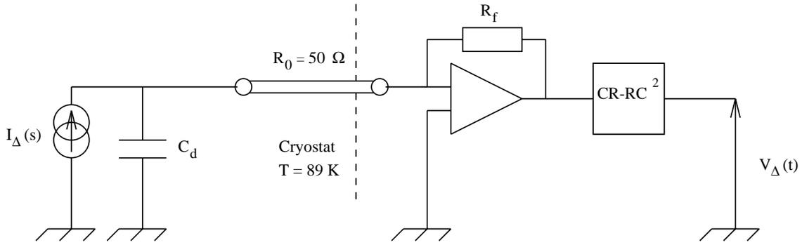
FIG. 3.4: Schéma de principe de la chaîne électronique du pré-échantillonneur.
