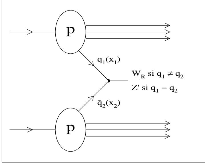
FIG. 4.1: Production des bosons  $W_R$  et  $Z'$  dans un processus de type Drell-Yan.
