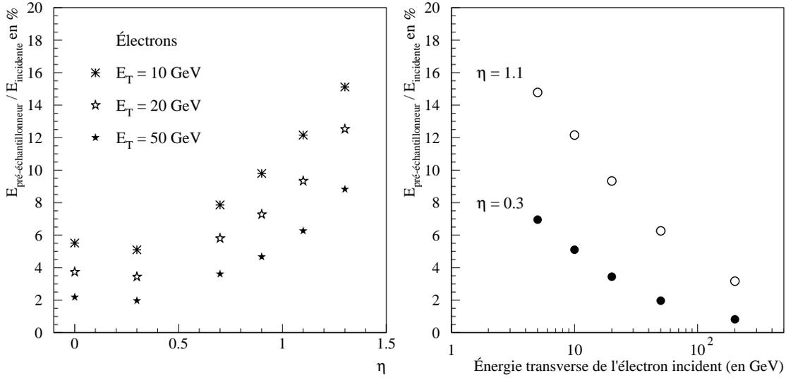
FIG. 3.19: Variations avec  $\eta$  et  $E_{inc}$  de la fraction de l'énergie incidente qui est récoltée dans le pré-échantillonneur (seul le cas des électrons a été traité sur les figures ci-dessus mais des résultats analogues sont obtenus avec les photons).
