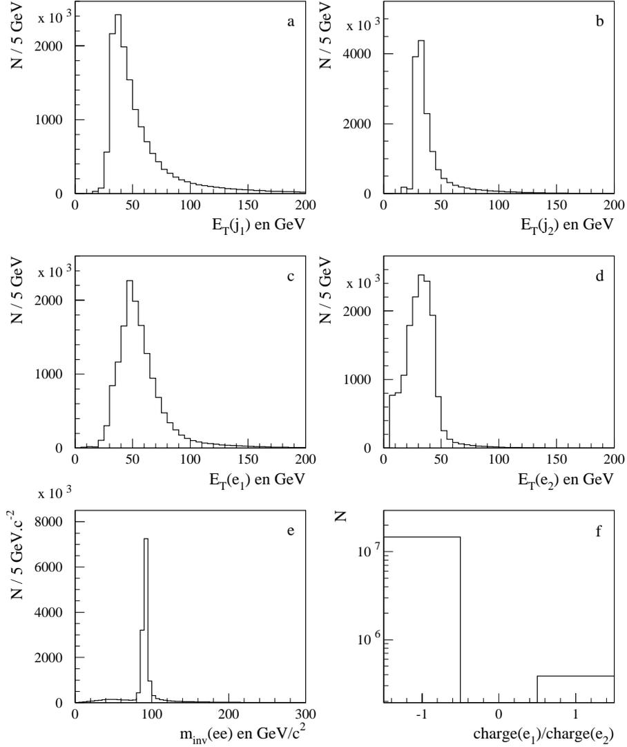
FIG. 5.4: Principales signatures expérimentales des bruits de fond physiques associés à  $pp \rightarrow W_R \rightarrow eN_e$  dans ATLAS. Les courbes ont été normalisées à une luminosité intégrée de  $3 \times 10^5 \text{ pb}^{-1}$ .
