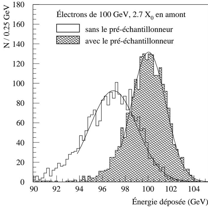
FIG. 3.30: Spectre en énergie obtenu pour des électrons de 100 GeV et une épaisseur de matière égale à  $2.7 X_0$ , avec et sans le pré-échantillonneur (deux cellules de détection y sont prises en compte).
