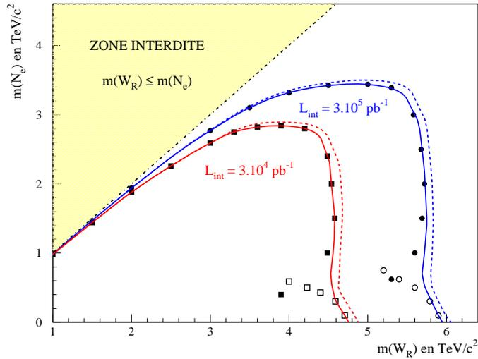
FIG. 5.10: Potentiel de découverte de  $W_R$  et  $N_e$  dans le détecteur ATLAS quand les coupures appliquées pour réduire le bruit de fond sont :  $m_{inv}(ee) \geq 200$  GeV/c<sup>2</sup>,  $E_T(j_1)$  et  $E_T(j_2) \geq 100$  GeV. Les contours pleins correspondent au cas où  $m_{N_e} = m_{N_\mu} = m_{N_\tau}$  et les contours en pointillés au cas où seul  $N_e$  peut être produit dans les décroissances du boson  $W_R$ .
