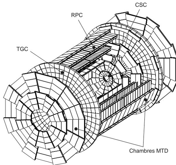
FIG. 2.12: Vue en perspective du spectromètre à muons d'ATLAS.
