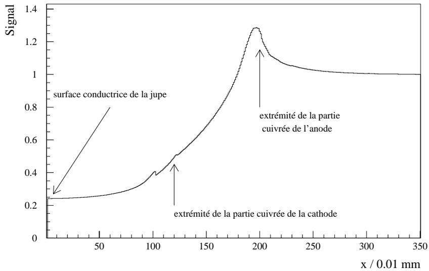
FIG. 3.9: Variation de la réponse du pré-échantillonneur en fonction de  $\phi$  (représenté selon l'axe x) au voisinage des zones mortes. On suppose que la collection des charges est uniforme selon  $\eta$ .
