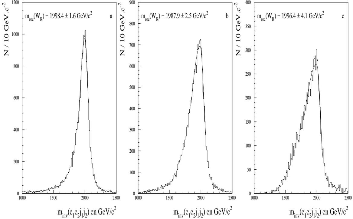
FIG. 5.3: Reconstruction du boson  $W_R$  dans le détecteur ATLAS, pour  $m_{W_R} = 2 \text{ TeV}/c^2$  et  $m_{N_e} = 0.5 \text{ TeV}/c^2$  (a),  $m_{N_e} = 1 \text{ TeV}/c^2$  (b) ou  $m_{N_e} = 1.5 \text{ TeV}/c^2$  (c). Les courbes sont données pour une luminosité intégrée de  $3 \times 10^5 \text{ pb}^{-1}$ , dans le cas où  $m_{N_e} = m_{N_\mu} = m_{N_\tau}$ . Pour retrouver la masse de  $W_R$ , on approxime le pic par une distribution gaussienne asymétrique.
