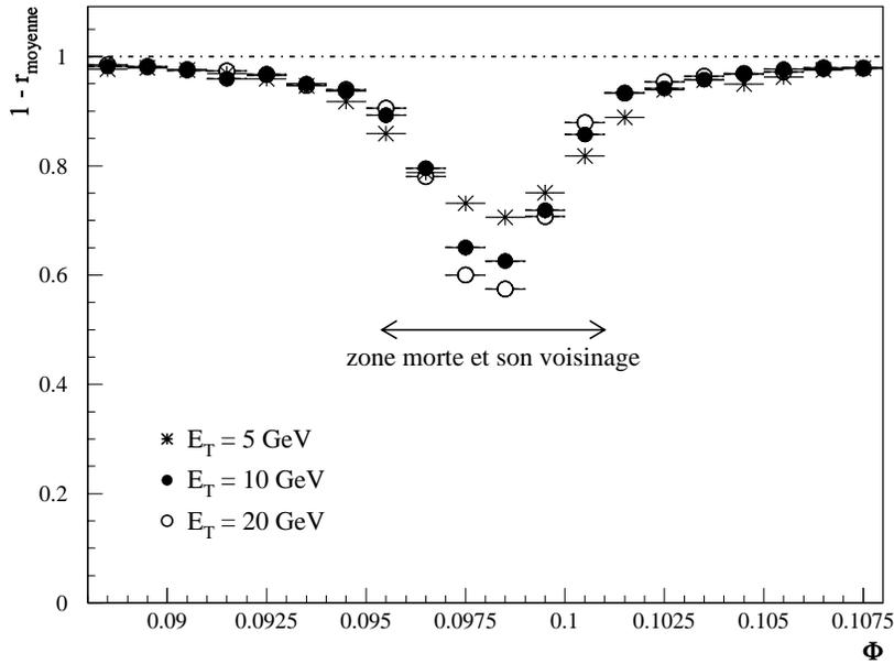
FIG. 3.11: Énergie moyenne collectée dans le pré-échantillonneur en fonction de  $\phi$  au voisinage des zones mortes, en l'absence de champ magnétique dans le détecteur interne : des électrons ayant une énergie transverse  $E_T$  de 5, 10 et 20 GeV ont été générés avec  $\eta = 0.9$  et avec  $0.088 \leq \phi \leq 0.108$ .
