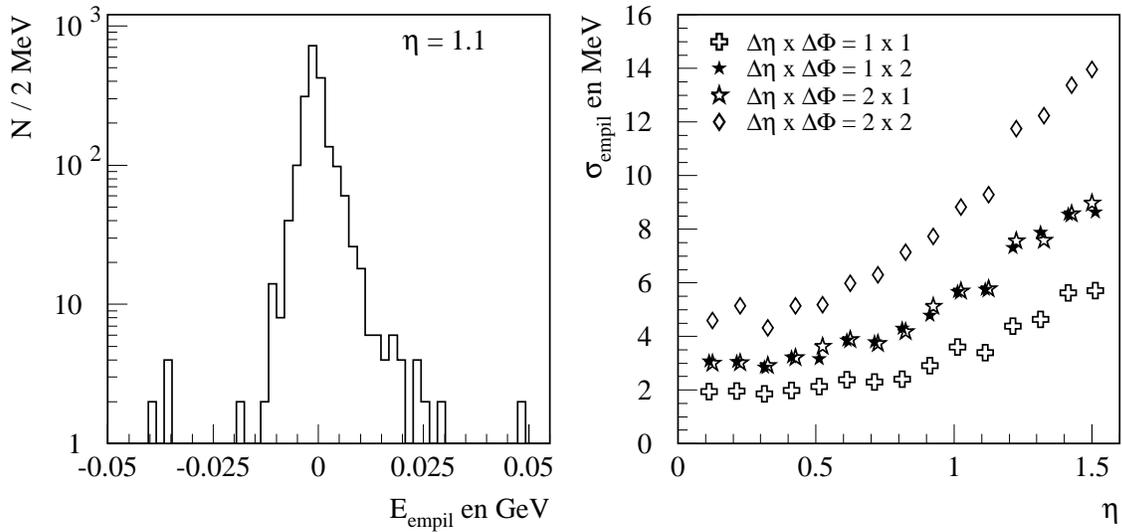
FIG. 3.14: Spectre en énergie des événements à biais minimum dans une cellule du pré-échantillonneur et variations du bruit d'empilement avec  $\eta$  et avec le nombre de cellules considérées (le temps caractéristique des formeurs vaut 15 ns).
