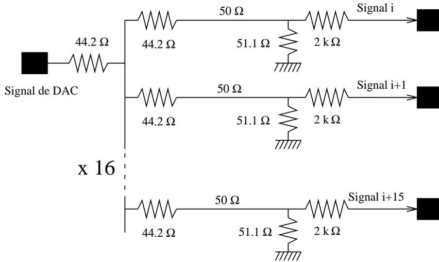
FIG. 3.22: Schéma électronique du système d'étalonnage du pré-échantillonneur.
