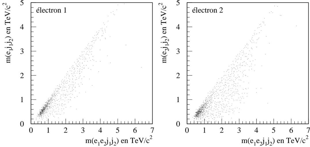
FIG. 5.9: Répartition du bruit de fond dans les plans  $(m_{inv}(e_1e_2j_1j_2); m_{inv}(e_1j_1j_2))$  et  $(m_{inv}(e_1e_2j_1j_2); m_{inv}(e_2j_1j_2))$  après avoir utilisé les coupures cinématiques suivantes :  $m_{inv}(ee) \geq 200 \text{ GeV}/c^2$ ,  $E_T(j_1)$  et  $E_T(j_2) \geq 100 \text{ GeV}$ .
