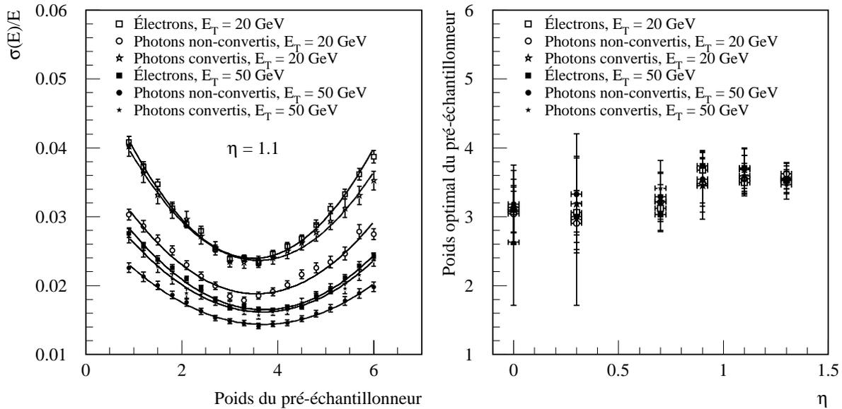
FIG. 3.16: Variations de la résolution en énergie du calorimètre électromagnétique avec le poids associé au pré-échantillonneur à  $\eta = 1.1$  (figure de gauche) et variations du poids optimal pour le pré-échantillonneur avec la position de l'électron ou du photon incident (figure de droite).
