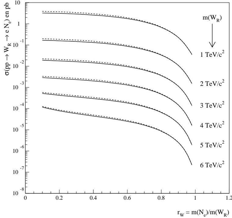
FIG. 5.1: Section efficace associée au processus  $pp \rightarrow W_R \rightarrow eN_e \rightarrow eeq_i\bar{q}_j$ . Les traits pleins correspondent au cas où  $m_{N_e} = m_{N_\mu} = m_{N_\tau}$  et les pointillés correspondent au cas où seul  $N_e$  peut être produit dans les décroissances du boson  $W_R$ .
