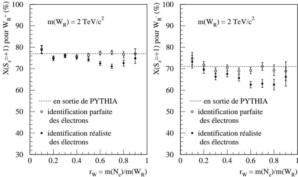
FIG. 5.16: Proportions de bosons  $W_R^+$  et  $W_R^-$  reconstruits dans l'état  $S_z = +1$ , quand  $m_{W_R}$  vaut  $2 \text{ TeV}/c^2$  et pour diverses valeurs de  $m_{N_e}$ . La luminosité intégrée considérée ici vaut  $3 \times 10^5 \text{ pb}^{-1}$ .
