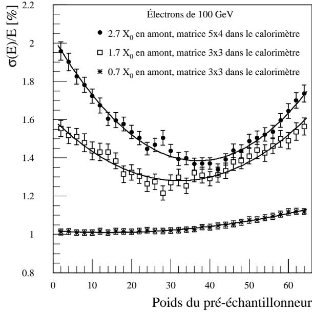
FIG. 3.29: Variations de la résolution en énergie du calorimètre électromagnétique avec le poids  $w$  du pré-échantillonneur et avec la quantité de matière placée en amont de ce dernier. Pour obtenir les résultats présentés sur cette figure, seule la cellule de coordonnées  $\eta = 4$  et  $\phi = 1$  est utilisée dans le pré-échantillonneur et la résolution en énergie du faisceau d'électrons, qui vaut 0.68%, est soustraite de façon quadratique.
