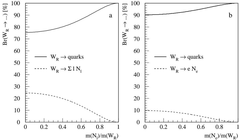
FIG. 4.4: Rapports de branchement des différentes voies de désintégration de  $W_R$ , dans le cas (a) où  $m_{N_e} = m_{N_\mu} = m_{N_\tau}$  et dans le cas (b) où seul  $N_e$  peut être produit dans les décroissances du boson. Les calculs ont été effectués avec  $m_{W_R} = 2 \text{ TeV}/c^2$ .
