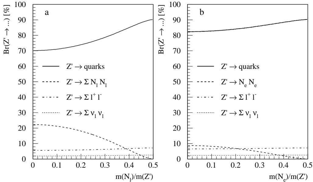
FIG. 4.5: Rapports de branchement des différentes voies de désintégration de  $Z'$ , dans le cas (a) où  $m_{N_e} = m_{N_\mu} = m_{N_\tau}$  et dans le cas (b) où seul  $N_e$  peut être produit dans les décroissances du boson. Les calculs ont été effectués avec  $m_{Z'} = 3 \text{ TeV}/c^2$ .
