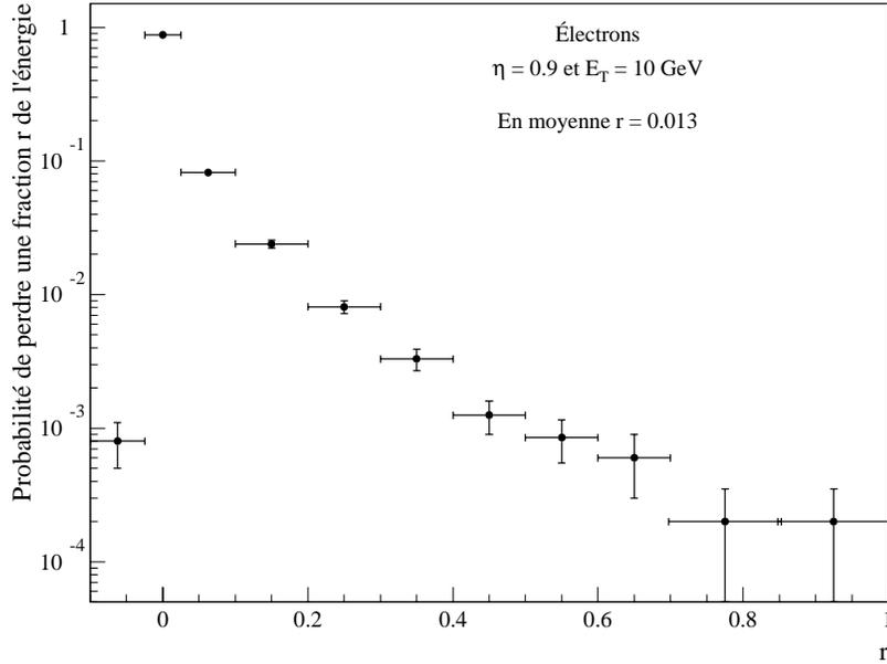
FIG. 3.12: Probabilités de perdre une fraction  $r$  de l'énergie du pré-échantillonneur à cause de ses zones mortes : des électrons ont été générés avec  $E_T = 10$  GeV,  $\eta = 0.9$  et  $0 < \phi < 2\pi$ . Si la gerbe électromagnétique se développe près de l'extrémité cuivrée de l'anode, où la collection des charges est maximale, alors  $r$  peut être négative.
