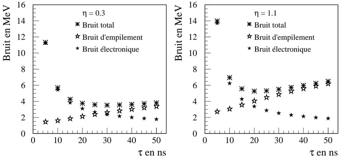
FIG. 3.15: Variation du bruit total dans le pré-échantillonneur avec le temps caractéristique des formeurs, pour  $\eta = 0.3$  et  $\eta = 1.1$  : une seule cellule a été utilisée et le bruit d'empilement a été calculé en supposant que le LHC fonctionne à haute luminosité.
