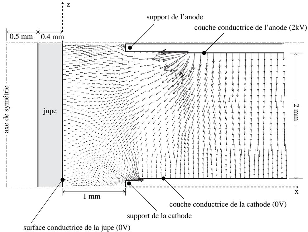
FIG. 3.7: Carte du champ électrique au voisinage des zones mortes entre les secteurs du pré-échantillonneur, dans le plan  $(\phi;\eta)$ . Les axes  $x$  et  $z$  correspondent respectivement aux directions  $\phi$  et  $\eta$ . Chaque flèche est un vecteur donnant localement la direction et l'intensité du champ électrique.
