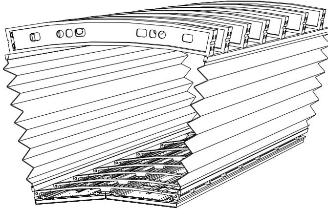
FIG. 2.6: Vue en perspective de deux secteurs du pré-échantillonneur placés sous un module du calorimètre électromagnétique d'ATLAS.
