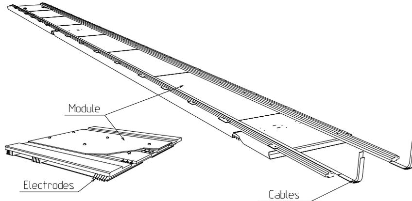
FIG. 3.3: Vue en perspective d'un secteur du pré-échantillonneur d'ATLAS.
