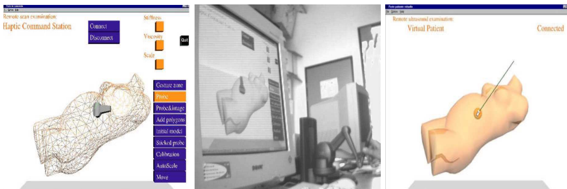
FIG. 5.5 – Station de commande haptique. (gauche)-Maillage du modèle virtuel. (milieu)- Utilisation de la station haptique. (droite)- Représentation graphique de la force exercée par la sonde sur le modèle virtuel.
