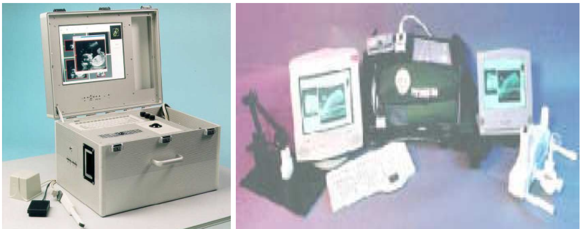
FIG. 2.9 – Système TeleInVivo. (gauche)-Système esclave. (droite)-Système maître.
