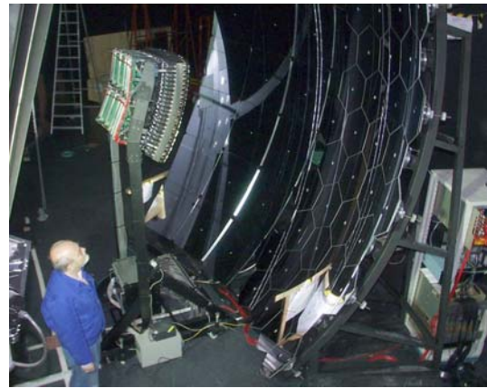
FIG. 2.6 – Photo d'un télescope à fluorescence sur le site de Malargüe. On y voit essentiellement le miroir et la caméra.
