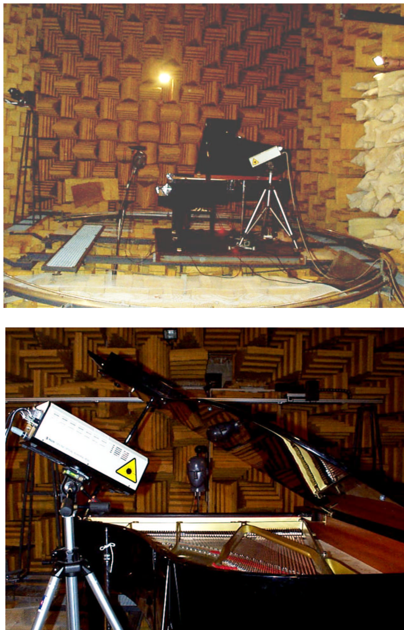
FIG. 5.13 – Photos du dispositif expérimental montrant le piano à queue dans la chambre anéchoïque du laboratoire : vue d'ensemble (photo du haut) et vue rapprochée (photo du bas).
