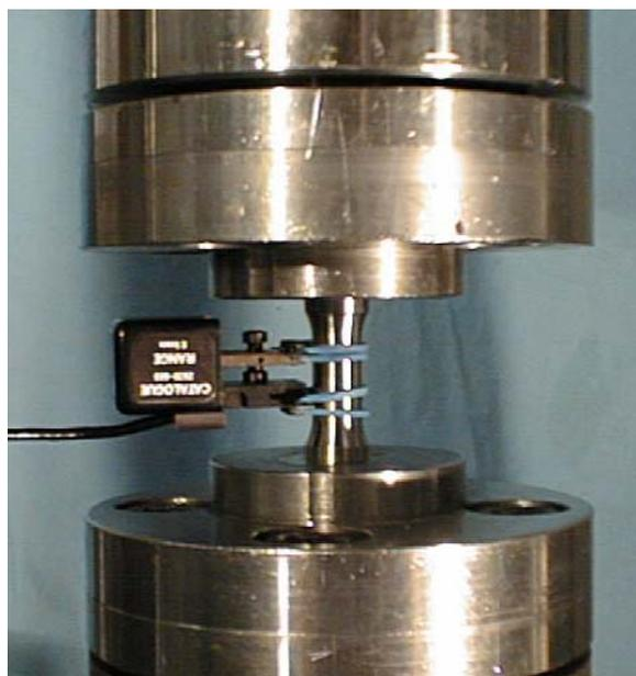
Figure II-4 : Montage de traction-compression
