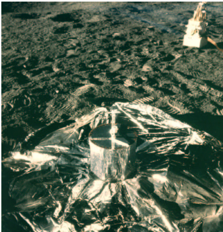
FIG. 1.6 – Le premier sismomètre de l'ALSEP installé par les astronautes d' Apollo 12 sur le sol lunaire, dans sa cloche, sous une couche de Mylar ® l'isolant du rayonnement solaire. [photo NASA]
