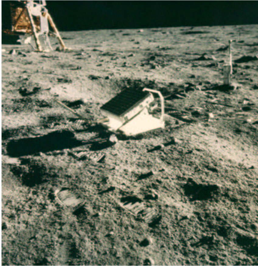
FIG. 1.5 – Rétro-réflecteur laser installé par les astronautes d’Apollo 11 à la surface de la Lune. [photo NASA]
