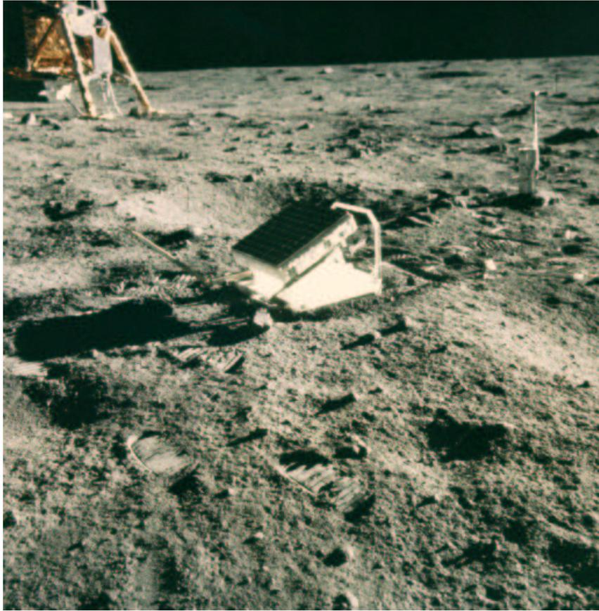
FIG. 1.5 – *Rétro-réflecteur laser installé par les astronautes d’Apollo 11 à la surface de la Lune. [photo NASA]*
