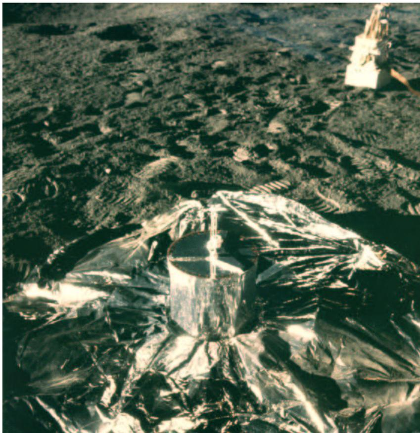
FIG. 1.6 – Le premier sismomètre de l'ALSEP installé par les astronautes d' *Apollo 12* sur le sol lunaire, dans sa cloche, sous une couche de Mylar<sup>®</sup> l'isolant du rayonnement solaire. [photo NASA]
