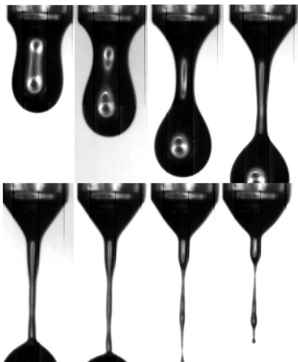
**FIG. 7.8:** Détachement d'une goutte de CTAB(0.5%)/NaSal(0.1%). On observe la formation d'un filament. Le temps total du montage photo est de 12ms.
