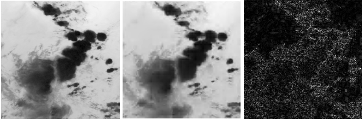
FIG. 5.4.: Compression d'image obtenue par quantisation des coefficients d'ondelette. De gauche à droite : image IR originale, reconstruction, erreur.
