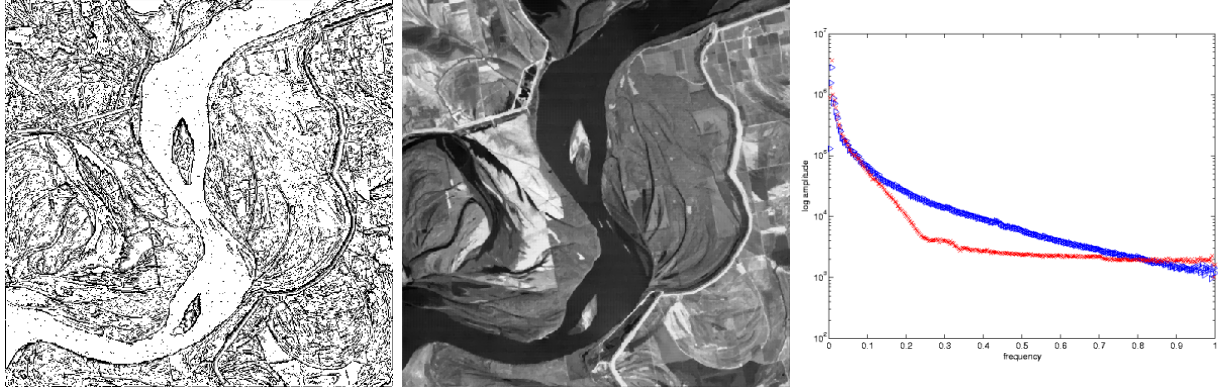
FIG. 5.28.: De gauche à droite : contour de l'image HR , image reconstruite et graphe des moyennes radiales des spectres de puissance \Gamma(\vec{\nu}) (représentation semi-log) ; en rouge l'image BR , en bleu l'image HR .
