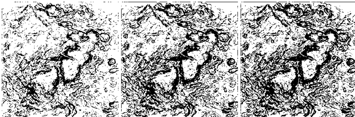
FIG. 5.22.: Estimation de la MSM à partir de la distribution de l'image de la figure 5.21. Le facteur discriminant ici est la densité d_\infty de la MSM dans l'image. De gauche à droite : d_\infty = 25\% , 35\% et 40\% .
