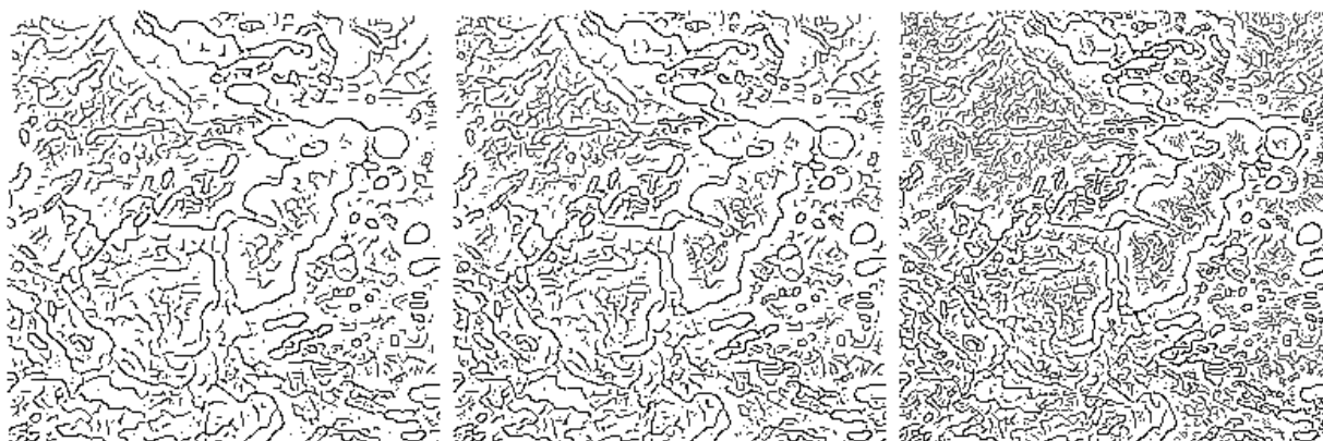
FIG. 5.23.: Contours détectés à l'aide de filtres de Dérivée. On ne représente ici que les maxima de la norme du gradient (aucun seuillage ultérieur n'est effectué). Le réglage de la largeur \alpha du filtre de l'équation (3.1) sert à affiner les détails. De gauche à droite : \alpha = 1., 1.2 et 1.8 .
