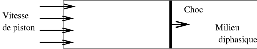
FIG. 3.8 – Représentation de l'impact d'un piston sur un milieu diphasique.
