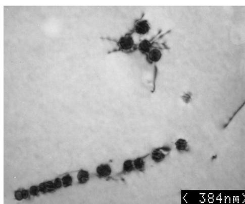
**Fig. 1.11** : Précipités sphériques observés au MET dans l'échantillon 12 après un traitement de revenu de 271 heures à  $450^\circ\text{C}$  (champ clair).
