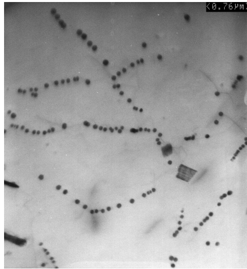
Fig. 1.12 : Alignement des précipités sphériques observés au MET dans l'échantillon 12 après un traitement de revenu de 271 heures à 450°C (champ clair).
