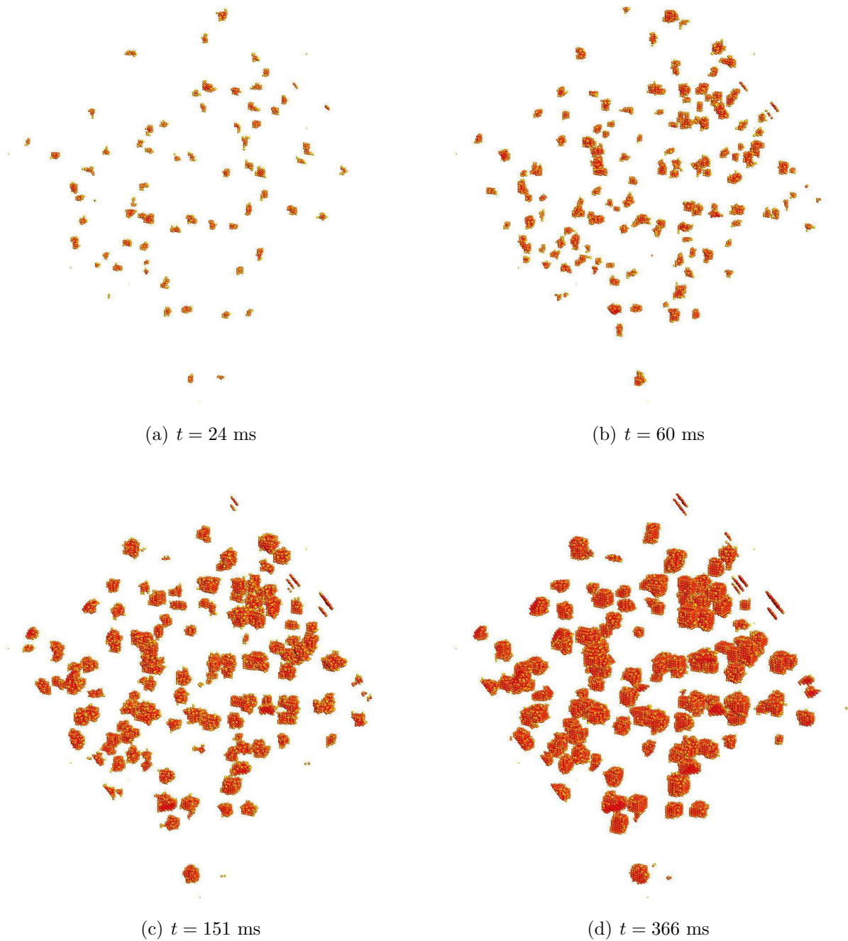
Fig. 2.7 : Simulation Monte Carlo de la précipitation de \text{Al}_3\text{Sc} pour une solution solide d'aluminium sursaturée de composition nominale x_{\text{Sc}}^0 = 0.5 at.% à T = 500^\circ\text{C} . La boîte de simulation comporte 8 \times 10^6 sites. Seuls les atomes Sc appartenant à des précipités \text{L1}_2 stables sont représentés, la taille critique utilisée étant n_{\text{Sc}}^* = 13 . Les atomes en rouge (sombres) ont 6 atomes Sc en position de seconds voisins et ceux en jaune (clairs) en ont un seul.
