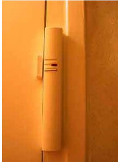
**Figure 18 : photo d'un contact de porte.**
