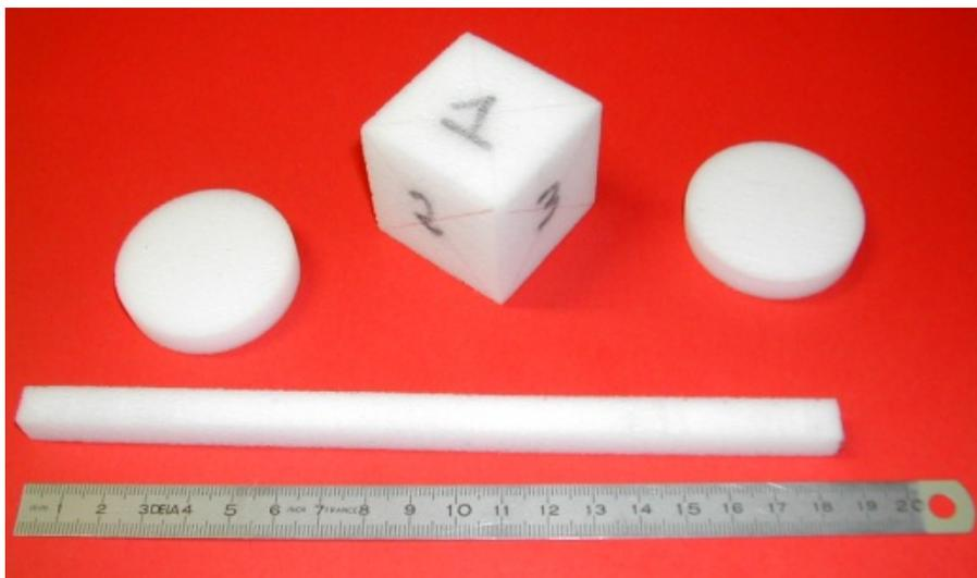
**Fig. 2.4:** Echantillons de la mousse de mélamine M testés dans ce chapitre. Ces échantillons proviennent d'un même volume ( $200 \times 100 \times 76 \text{ mm}^3$ ) de mousse.
