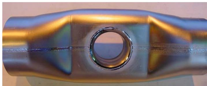
Les flancs ont été, quant à eux, réalisés par repoussage\* (Figure 5.6 ci-dessous).
