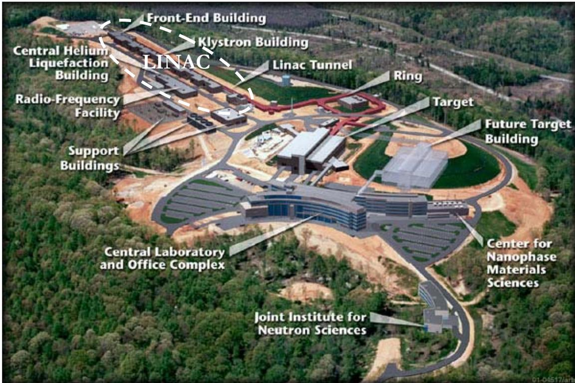
Figure 1.7 : Vue aérienne de SNS. Remarquons l'importance du Linac ( $L=331\text{ m}$ ).
