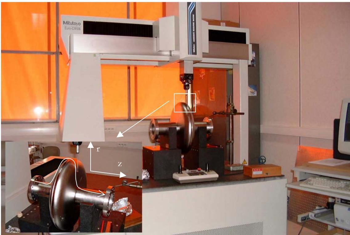
Figure 6.3 : Machine de contrôle dimensionnel avec la cavité Z101 lors d'une mesure de profil (schématiquement représenté en blanc sur le zoom).
