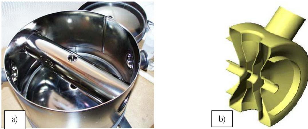
Figure 3.50 : a) Cavité  $\beta=0.4$  d'Argonne et b) cavité  $\beta=0.175$  de Los Alamos. Remarquons la différence de forme des deux barres centrales [112].
