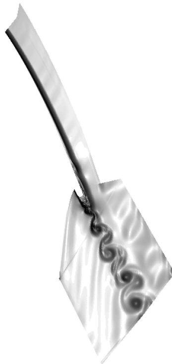
FIG. 8.10: Vue instantanée du champ fluctuant reconstruit (Représentation de type Schlieren)
