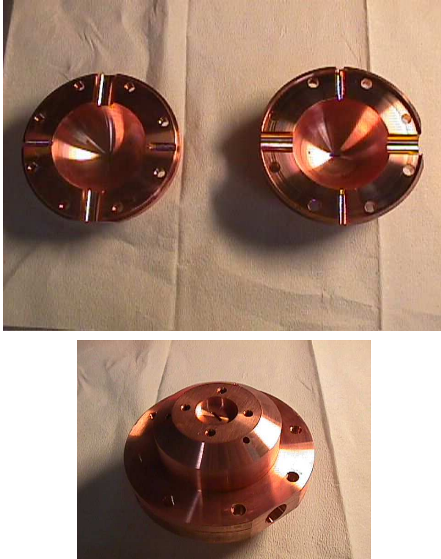
FIG. 6.1 – Photos de la cavité sphérique de test.
